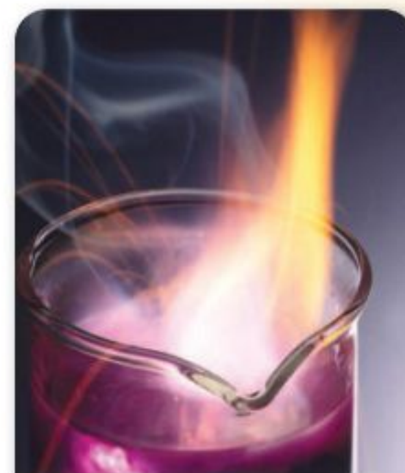
الشكل 1-10 يتفاعل فلز البوتاسيوم بشدة مع الماء مطلقاً كمية كبيرة من الحرارة كافية لإشعال غاز الهيدروجين الناتج واحتراقه.
